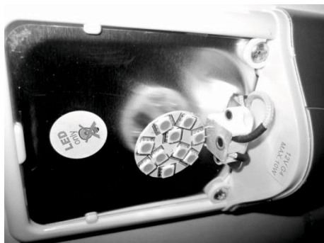
Fig. 222: Sostituire i corpi illuminanti a LED
