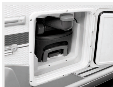
Fig. 50: Serbatoio acque nere con bocchettone di riempimento dell'acqua di risciacquo
