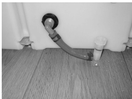
Fig. 97: Valvola di scarico, esempio
