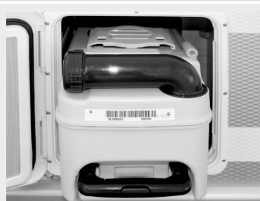
Fig. 49: Serbatoio acque nere
