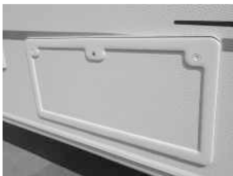
Fig. 19: cellula abitativa, vano di servizio esterno
