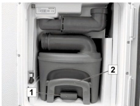
Fig. 199: Serbatoio acque nere nel vano WC
