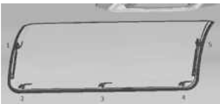
Kuva 37: Sisäkuva kaarevasta tuuletusikkunasta, jossa on viisi kiertosalvaa
