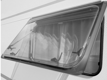
Kuva 33: Tuuletusikkunan kehys
