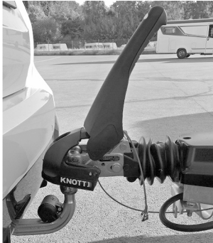
Kuva 13: Vetopään kytkentä auki, vakautus pois käytöstä
