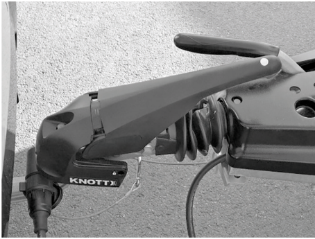
Kuva 10: Vetopään kytkentä suljettu, vakautus aktivoitu
