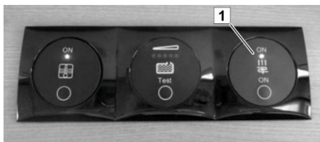
Bild 133: Strömbrytare för golvvärmen
