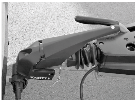
Bild 10: Släpvagnskopplingen stängd, stabilisering aktiverad
