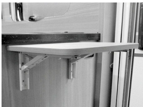
Bild 162: Fällbar konsol för att förlänga arbetsbänken
