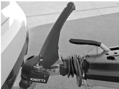
Bild 9: Släpvagnskopplingen stängd, stabilisering inaktiverad
