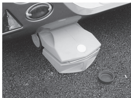
Kuva 114: Pyörillä varustettu jätevesisäiliö
