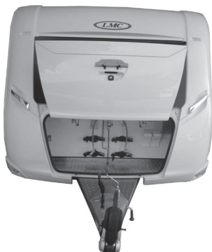
Kuva 76: Kaasupullokaapin kansi, auki
