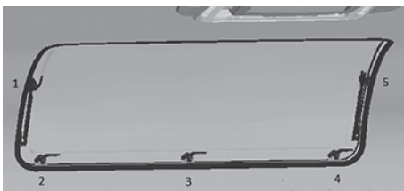
Kuva 28: Sisäkuva kaarevasta tuuletusikkunasta, jossa on viisi kiertosalvaa
