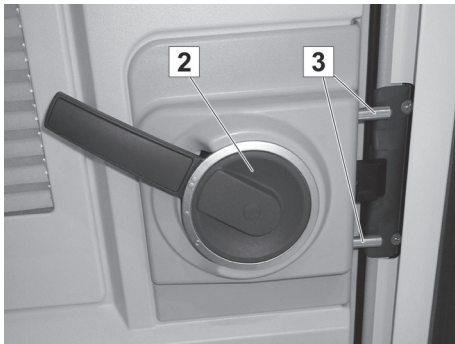
Kuva 17: Ovi suljettu ja varmistettu
